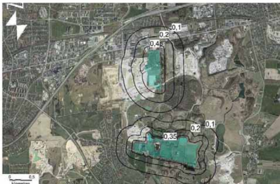
Figur 7-4: Illustration af teoretisk beregnede sænkningstragte i Hedehusene fra samtidig gravning under grundvandsspejlet i begge delområder. Sænkningen er vist på et fladt grundvandsspejl og angivet i meter.
