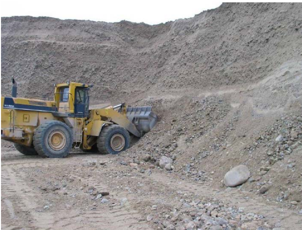
Figur 4: Gummiged graver grus ved gravefronten.
